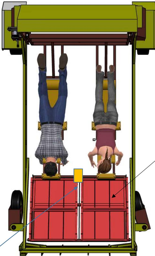
Un large plateau de stockage permet de charger jusqu'à 4 caisses de légumes (8 si on les superpose). Ce plateau est orientable pour s'adapter à la hauteur des maraîchers
