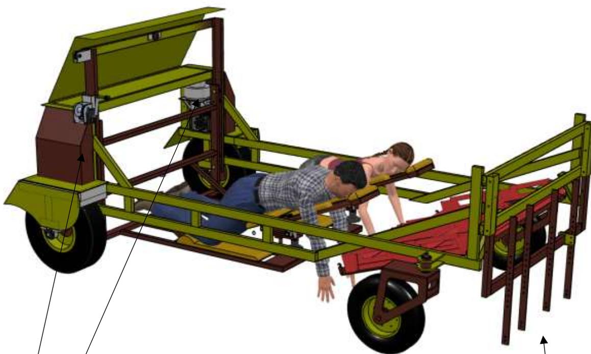
La propulsion s'effectue à l'aide de deux moteurs électrique à courant continu fonctionnant en 24V.
